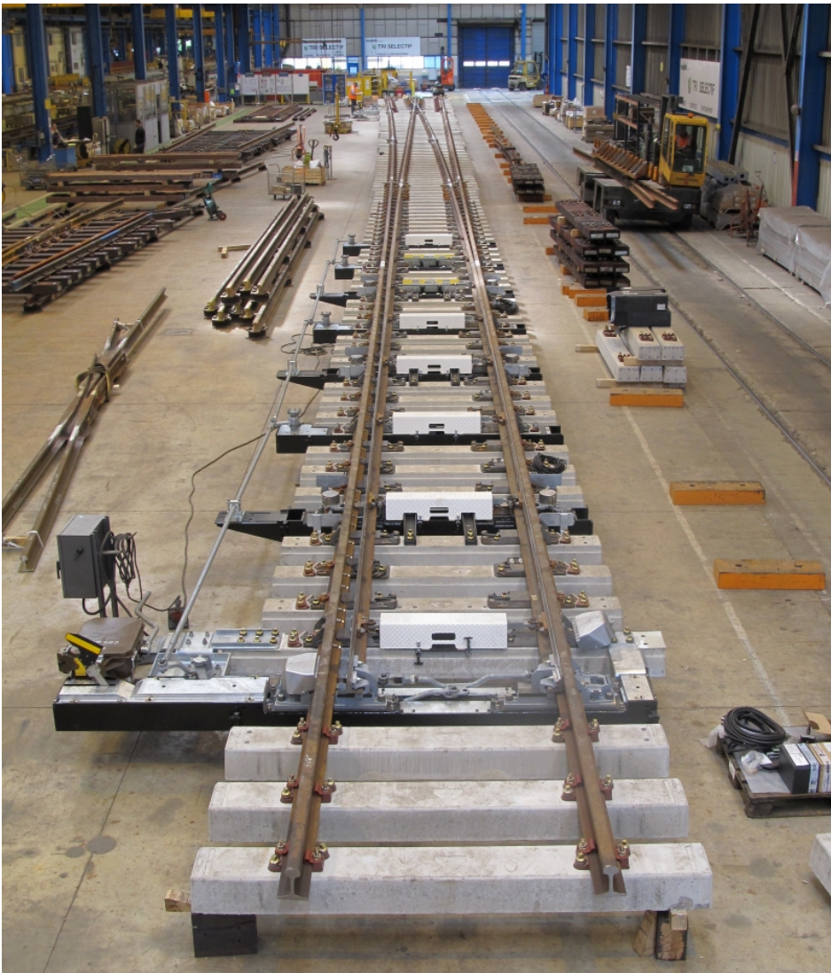
Weichenfertigung bei Vossloh in Frankreich (Bild: Vossloh).
