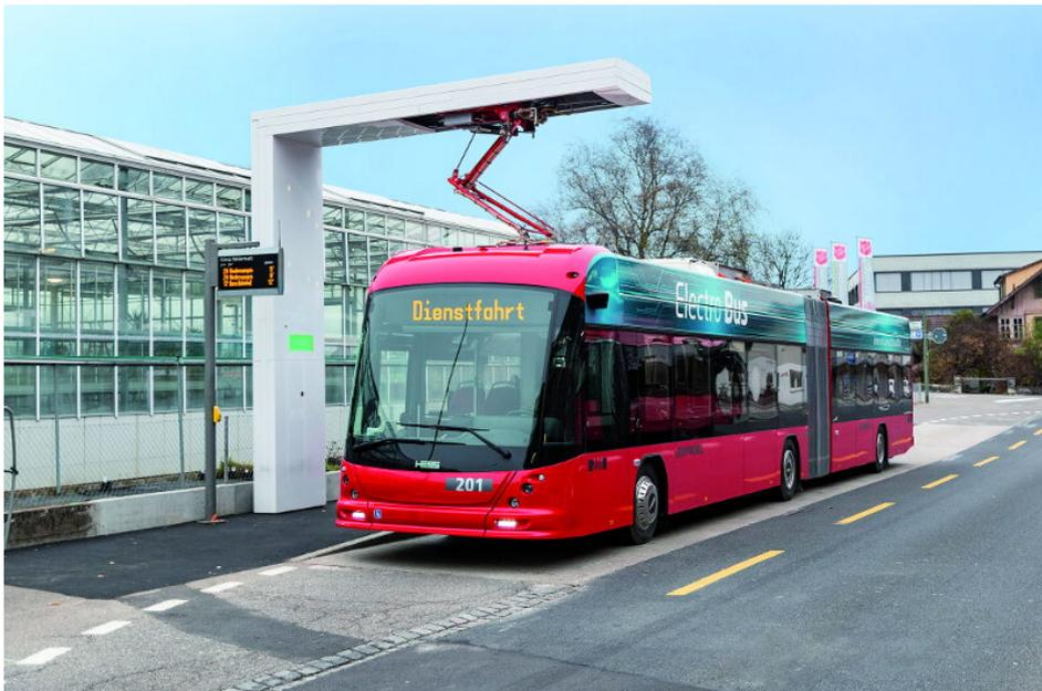
Hess lighTram 19 DC Elektro-Gelenkbus mit 18,7 m Länge und Schnellladeeinrichtung.
