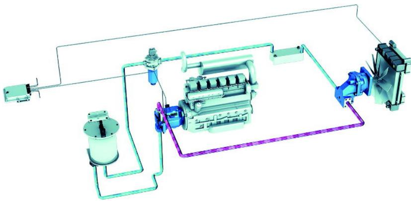
Modularer Baukasten für komplett Kühlanlagen: Rexroth setzt auf stufenlos regelbare Antriebslösungen zur Reduzierung des Dieselsverbrauchs von Schienenfahrzeugen.
