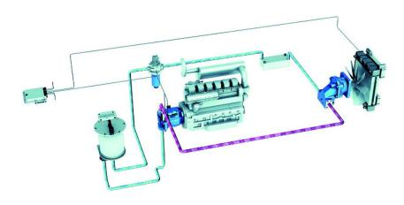
Modularer Baukasten für komplette Kühlanlagen: Rexroth setzt auf stufenlos regelbare Antriebslösungen zur Reduzierung des Dieselsverbrauchs von Schienenfahrzeugen.
