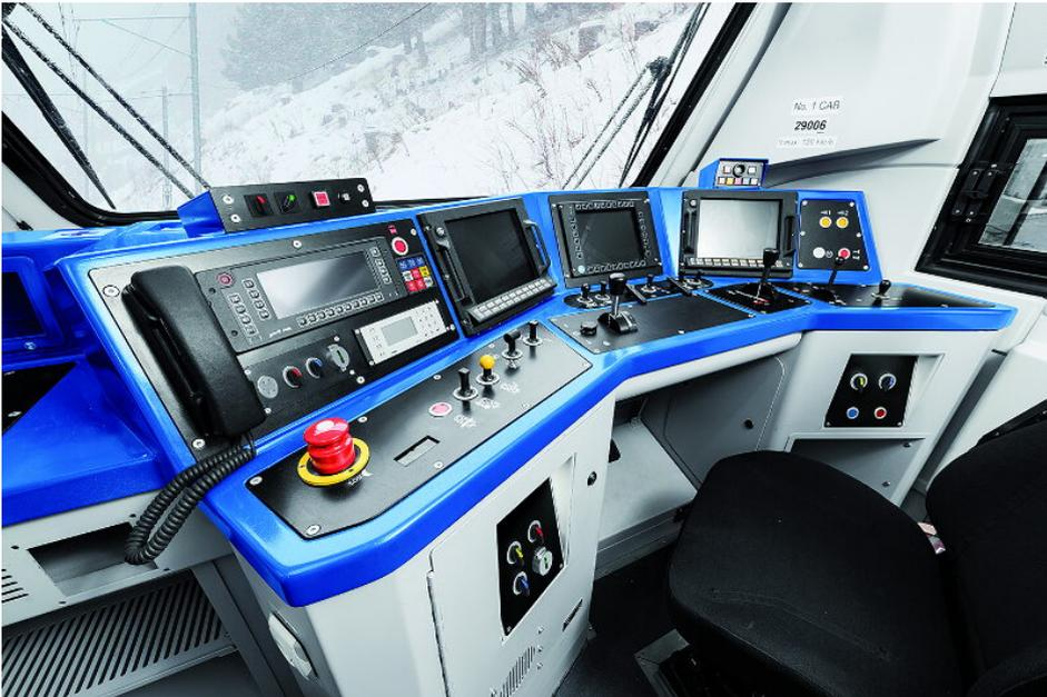
Die EAO Baureihe 04 ausleuchtbare Wahlschalter. Mit ein- oder zweifarbiger LED-Ausleuchtung erhöhen die modernen Wahlschalter auf intuitive und optisch rasch erkennbare Weise die Bediensicherheit am Fahrerarbeitsplatz und Bedienfeld.
