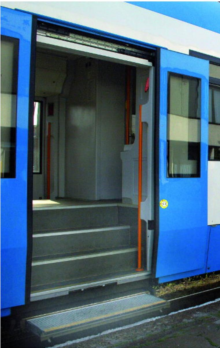
Türöffnungstaster mit sogenanntem Sanduhreffekt werden in der Regel bei ausfahrenden Schiebetritten oder Klapprampen eingesetzt (TSL-Escha).
