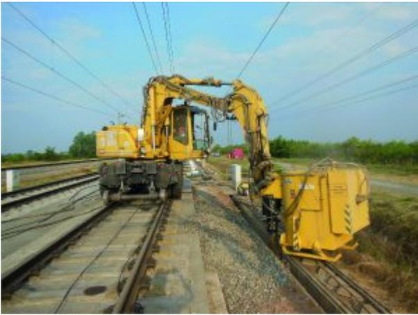
Baggeranbausauger tinbin TC2, montiert an einem ZW-Bagger, bei der Reinigung eines Kabelkanals (BSB-Saugbagger).
