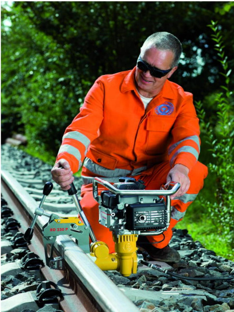
Die Schienenbohrmaschine RD 330 P wird mit einer Schnellspannvorrichtung am Schienenkopf befestigt (Goldschmidt Thermit).
