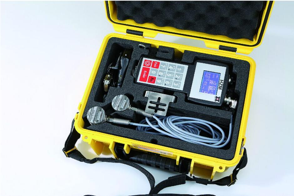
Das Kraftmessgerät HZM von Hanning & Kahl besitzt die Anwenderfreigabe der DB Netz AG zur Prüfung von Weichenstellsystemen.
