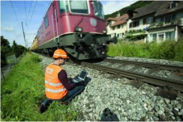
Rawloc von Hastema auf offener Strecke. An den Schienen sind die seitlich angebrachten Abdeckbleche zu erkennen, darunter liegen die Dehnungsmessstreifen.
