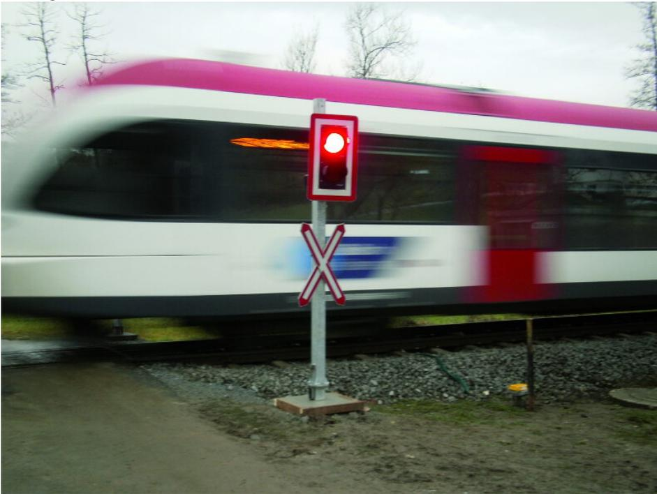
Eisenbahnkreuzungssysteme von Zelisko reduzieren das Risiko beim Zusammentreffen von Schienen- und Straßenverkehr (Knorr-Bremse).
