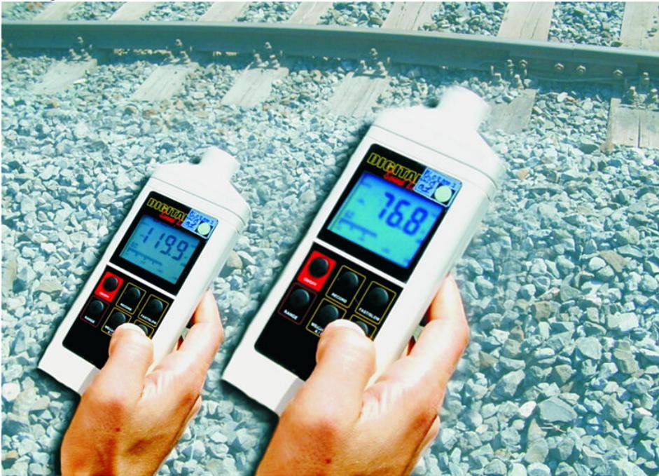
Nachweislich effektive Maßnahme gegen Quietsch- und Kreischgeräusche. Messung vor der Konditionierung (links) und nach der Konditionierung mit Sintono Terra HLK von Lubricant Consult.
