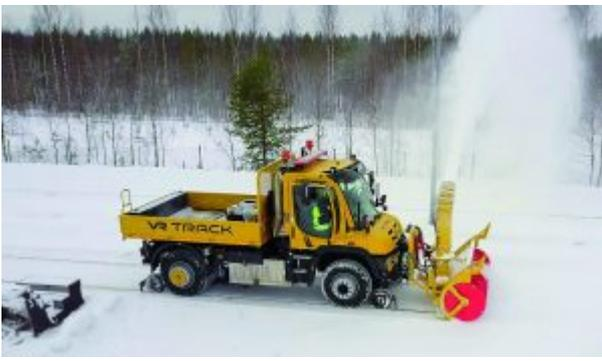
Der Unimog im 2-Wege-Einsatz kann z. B. im Frontanbau mit Kehrwalze, Schneepflug oder Schneefräse ausgerüstet werden.
