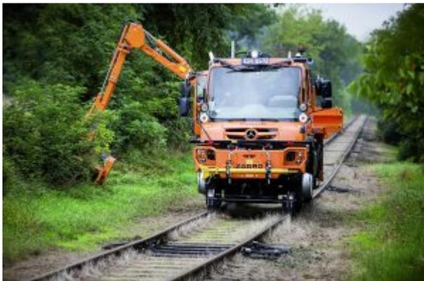
Der Unimog mit Mähhausleger erfüllt die sicherheitsrelevante Software EN 50128 zur EBA-Abnahme des Eisenbahnbundesamts.
