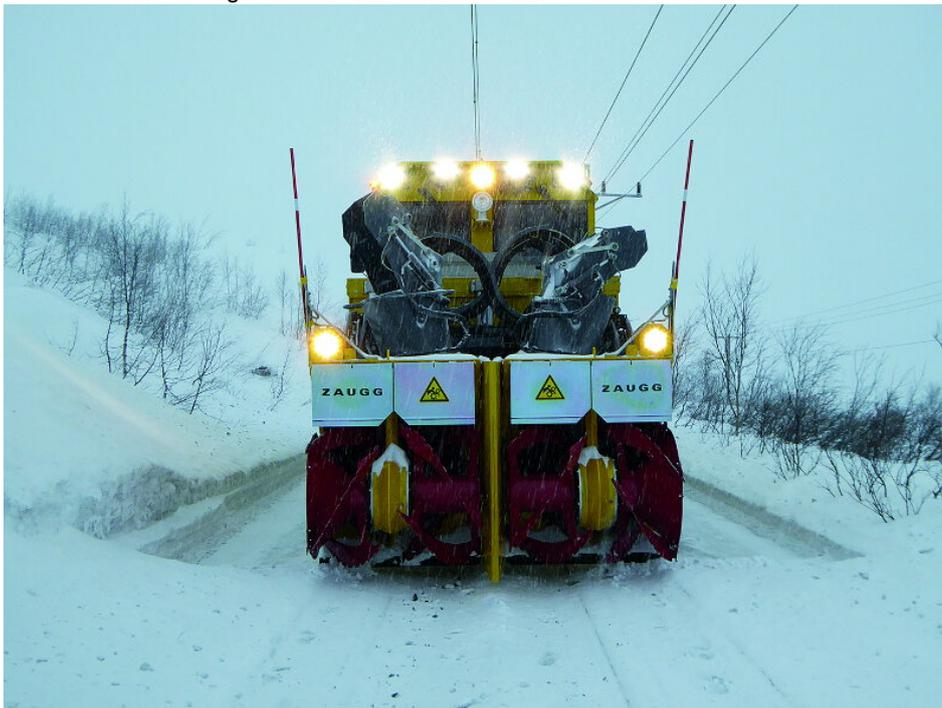
Die Schneeräumlokomotive verfügt über zwei unabhängige Schneefrässchleudern. Jede davon ist mit einem flexiblen Auswurfkamin versehen. Beim ersten Schneeräumdurchgang sind die beiden Einheiten zusammen. Bei der Rückkehr bzw. beim zweiten Durchgang sind die Schneefrässchleudern nach beiden Seiten ausgefahren (Zaugg).
