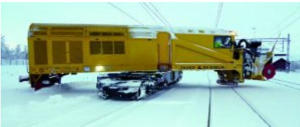
Um die Arbeitsrichtung zu ändern, kann der Oberwagen in zwei Minuten um 180° gedreht werden (Zaugg).
