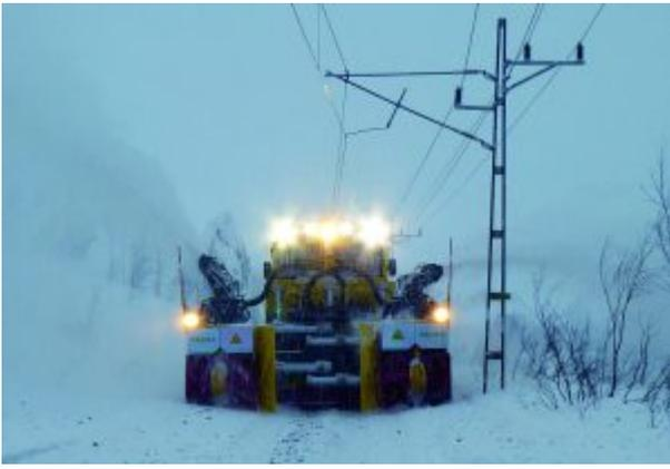
Da der Kunde einen rein hydrostatischen Antrieb wünschte, der eine optimale Leistungsverteilung zwischen Fahr- und Fräsantrieb ermöglicht, kam als Unterlieferant die auf Gleisbaumaschinen spezialisierte Firma Matériel Industriel SA in Crissier bei Lausanne zum Zug. Diese hat entsprechende Antriebe im Angebot. MATISA ist zudem für das Fahren und die Verkehrszulassung des Fahrzeugs in Schweden zuständig.
