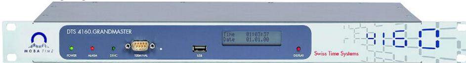
Der Bürk Mobatime DTS 4160 Timeserver (Front- und Rückansicht) bietet bis zu vier LAN-Schnittstellen Ipv4/IPv6).
