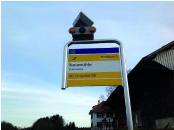
Zur Installation von Swiss Innovation Lab gehört ein Solar-Panel zur Speisung und der Haltestellentaster, der zusätzlich auch eine Einstiegshilfe verlangen kann.
