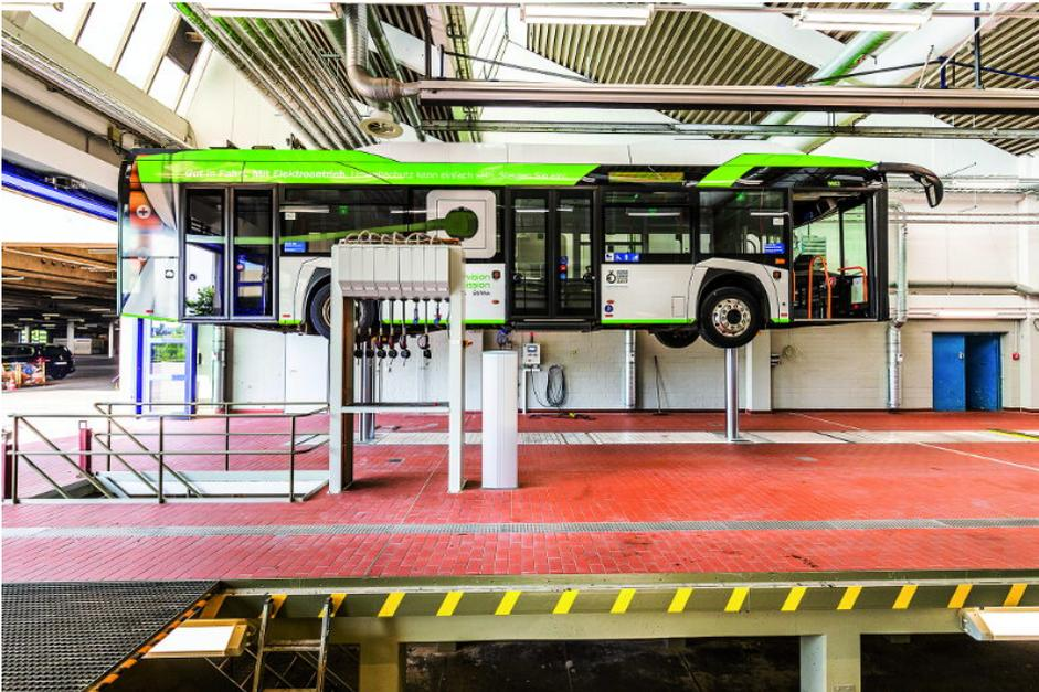
Die Hebeanlagen von J.A. Becker befördern praktisch alle Fahrzeuge bis hin zu Sonder- und Schienenfahrzeuge in eine ergonomische Arbeitshöhe.
