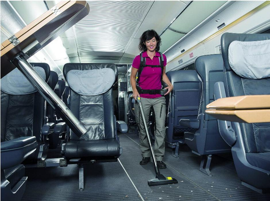
In dem Kärcher Rucksacksauger BV 5/1 Bp kommt ein Lithium-Ionen-Akku zum Einsatz, dank dem der Sauger über ca. 46 min (im eco-Modus) die gleiche Leistung wie ein netzbetriebenes Gerät liefert.
