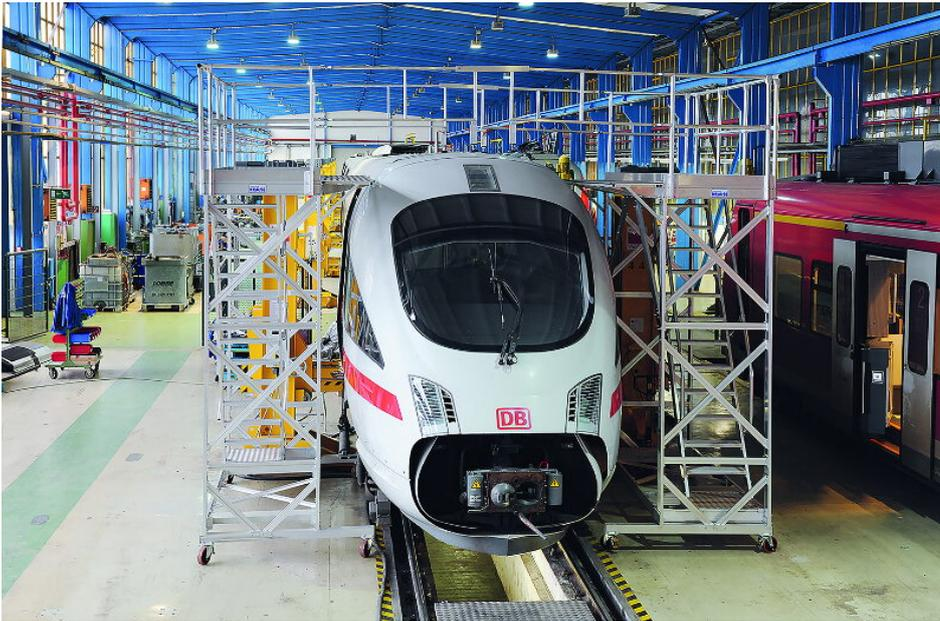
Krause-Werke bietet auch für den Bahnbereich optimale Zugangs- und Steiglösungen, wie z.B. individuell gefertigte Dacharbeitsstände.
