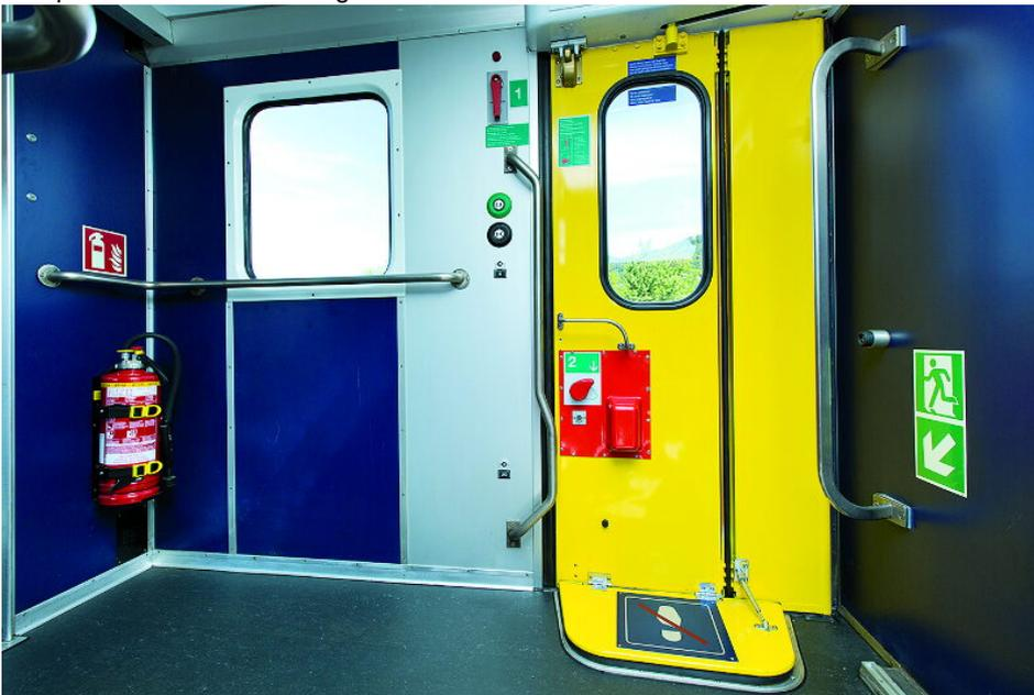
Eine »Totalsanierung« einer Drehfalttüre eines älteren SBB-Wagens, um auf den geforderten Sicherheitsstandard zu kommen (Schaltbau Refurbishment).
