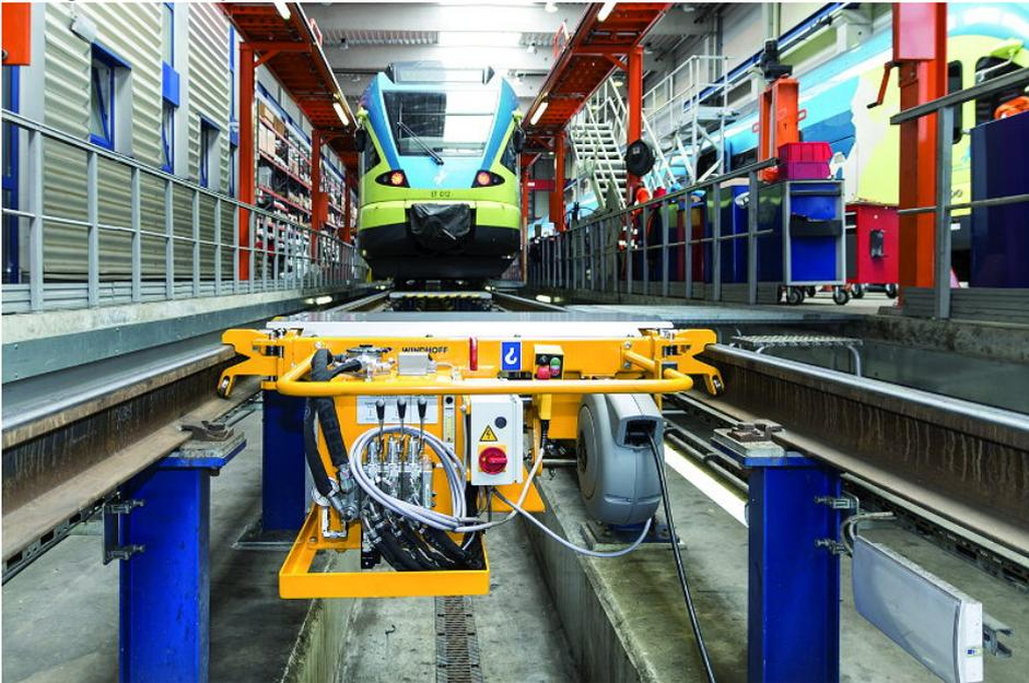
Radsatzdreheinrichtungen werden auch für visuelle oder messtechnische Prüfungen an stehenden Schienenfahrzeugen eingesetzt (Windhoff).
