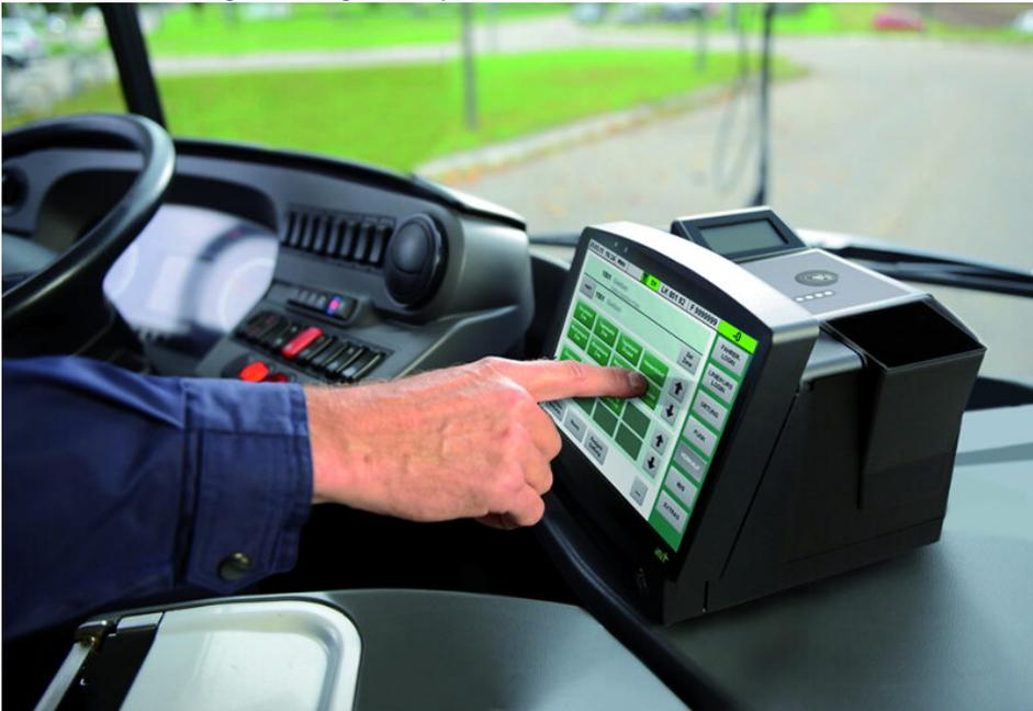
GeBE Standard-Thermodrucker erfüllen häufig bereits die Anforderungen der OEMs aus dem Bereich des öffentlichen Verkehrs. So wie im Init Bordrechner EVENDpc2, Und der GeBE Cutter schneidet darin sauber die Fahrscheine ab.
