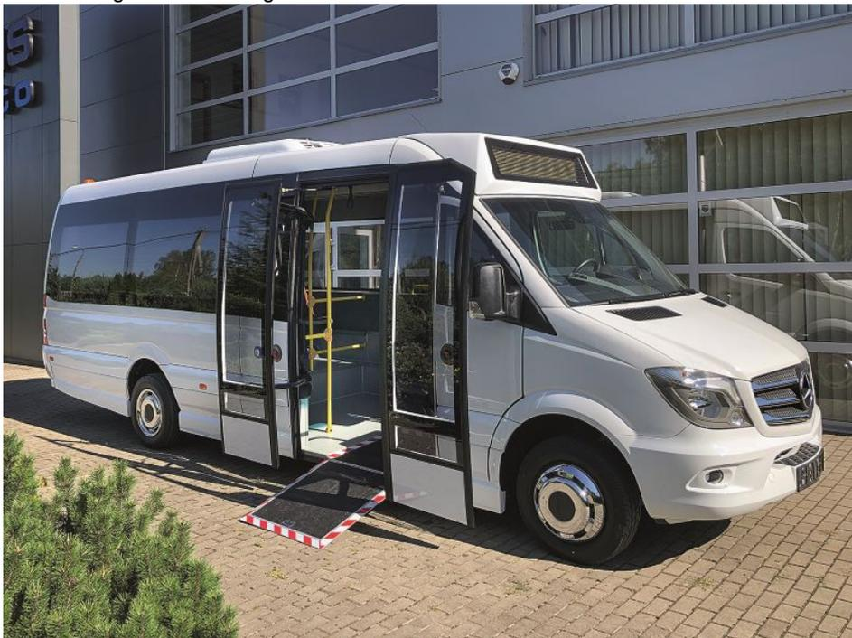
ProBus Sprinter LE Low-Entry Minibus auf Mercedes-Benz-Sprinter Chassis (Bild: ProBus).
