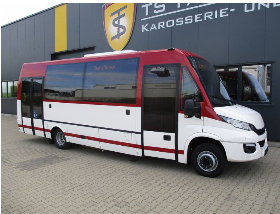
TS Heckniederflurbus auf Basis Iveco Daily 70 C 17 (Bild: TS Fahrzeugtechnik).
