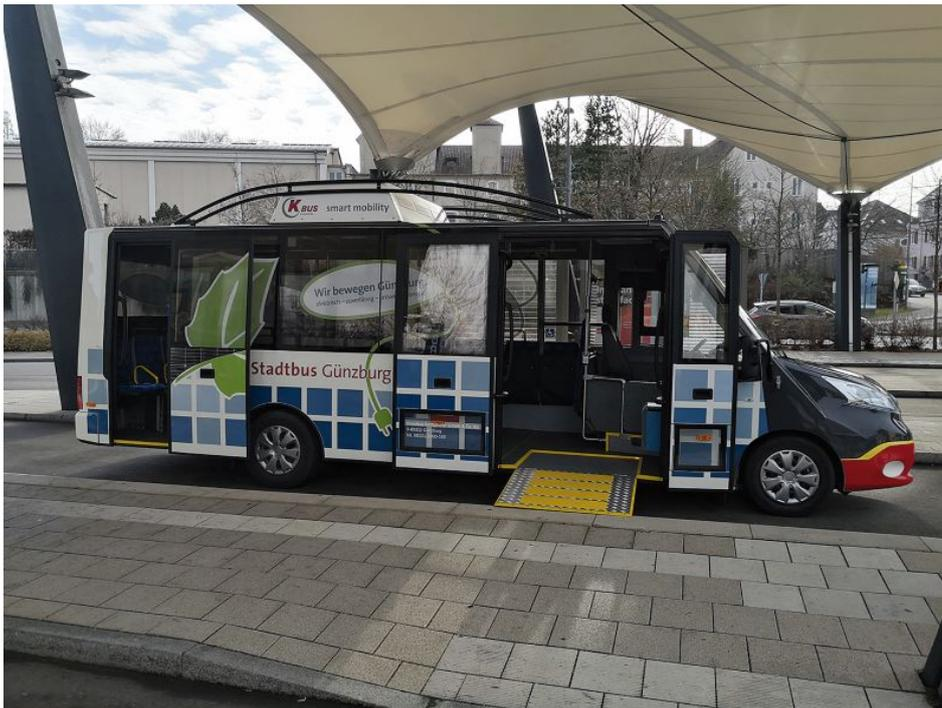
K-Bus E-Solar City III, batterieelektrischer Kleinbus mit Solarpanels als Range-Extender, Einsatz in der Stadt Günzburg (Bild: K-Bus).
