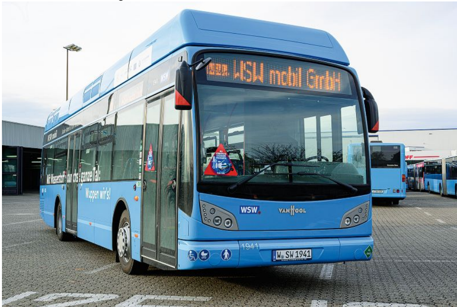
Van Hool A 330 FC, Brennstoffzellenhybridbus in Diensten der WSW Mobil, Wuppertal (Bild: Stefan Tesche-Hasenbach).
