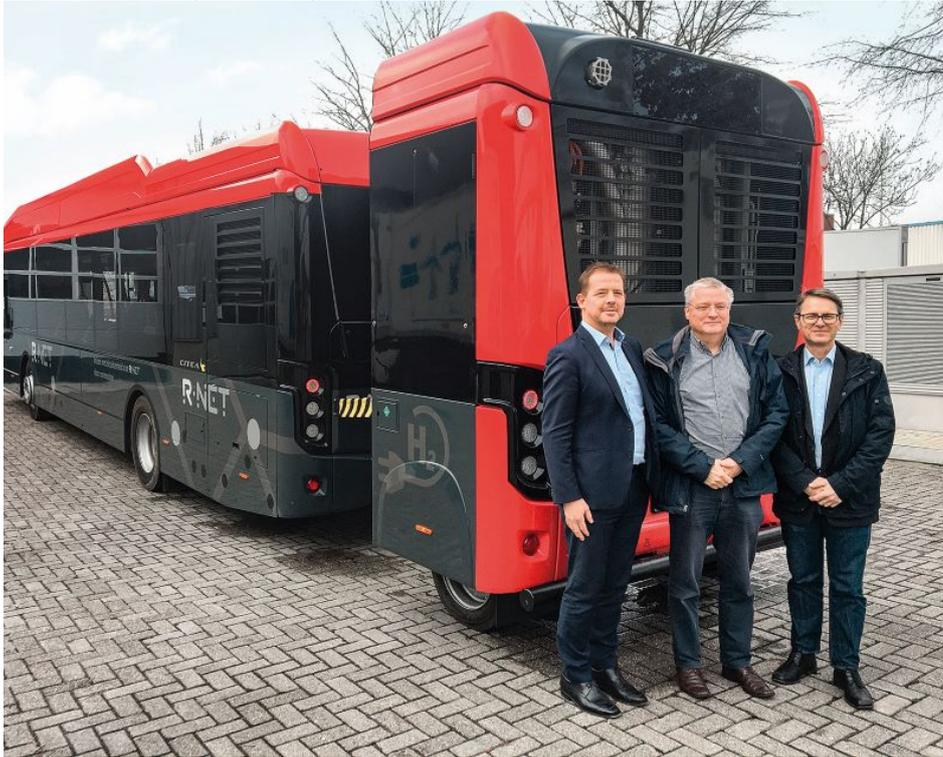
VDL Citea SLF 120 electric mit BzH Range-Extender-Anhänger im Rahmen des Giantleap-Projekts (Bild: EllringKlinger).
