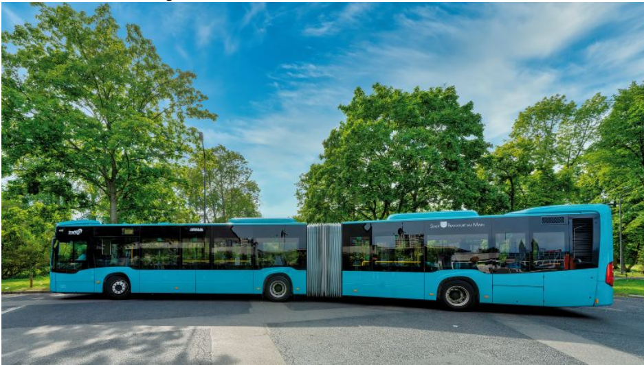
Mercedes-Benz Citaro G, Gelenkbus mit Euro-VI-Dieselmotor OM 936 h und 260 kW (354 PS) Leistung (Bild: ICB GmbH, Frankfurt am Main).
