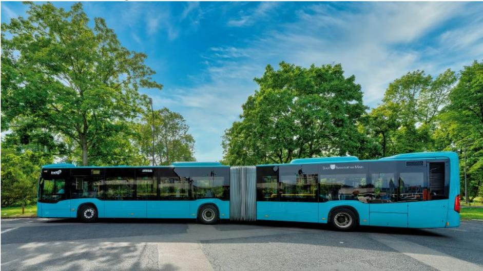
Mercedes-Benz Citaro G, Gelenkbus mit Euro-VI-Dieselmotor OM 936 h und 260 kW (354 PS) Leistung (Bild: ICB GmbH, Frankfurt am Main).
