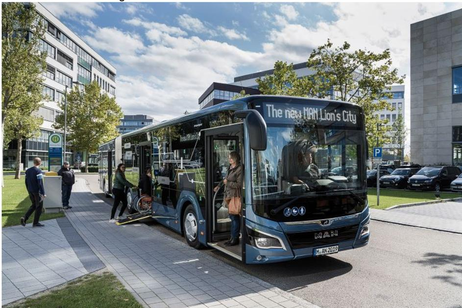
MAN Lion's City 19, Gelenkbus mit 18,75 m Länge und Euro-VI-Dieselmotor (Bild: MAN Truck & Bus).
