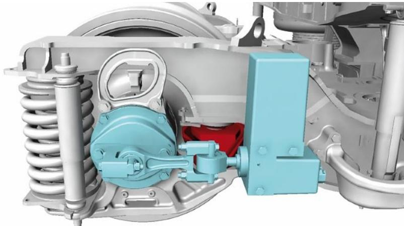
Die Aktive-Radsatz-Steuerung ARS von Bombardier: Die Radachse wird permanent genau senkrecht zur Gleisrichtung eingestellt.
