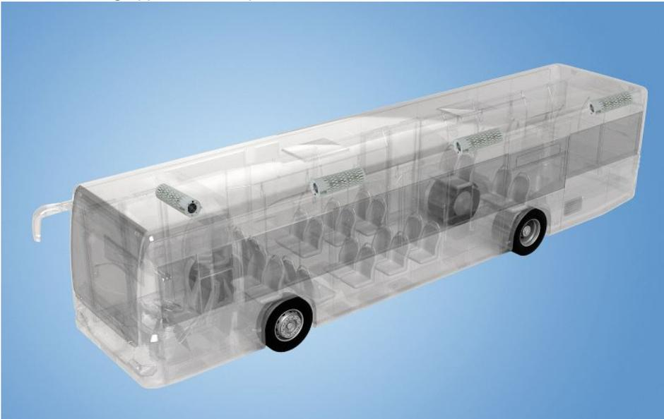
Die Luftfiltersysteme können in alle Fahrzeuginnerräume, z. B. Busse und Straßenbahnen, nachgerüstet werden (Bild: Webasto).
