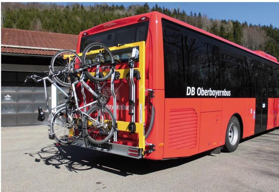
Mit dem Huckepack Typ »HLT 5/H« lassen sich am Heck eines Omnibusses bis zu fünf Fahrräder im Linienverkehr mitführen (Bild: Franz Harbeck).
