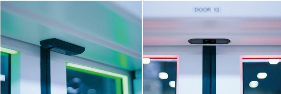
Mehrfach für sein Design ausgezeichnet wurde das Fahrgastzählsystem IRMA 6 der iris-GmbH. Modernste Signalverarbeitung ermittelt zuverlässig ein- und aussteigende Fahrgäste sowie relevante Objekte wie Gepäck, Rollstühle, Kinderwagen und Fahrräder.
