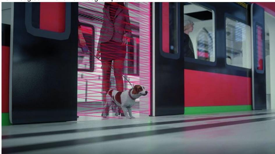
Das vollautomatische Lichtgitter »SITRANS alpha« steht für eine berührungslose Türüberwachung. Weltweit wurden bereits mehr als 90.000 Türen damit ausgerüstet (Bild: Sitron).
