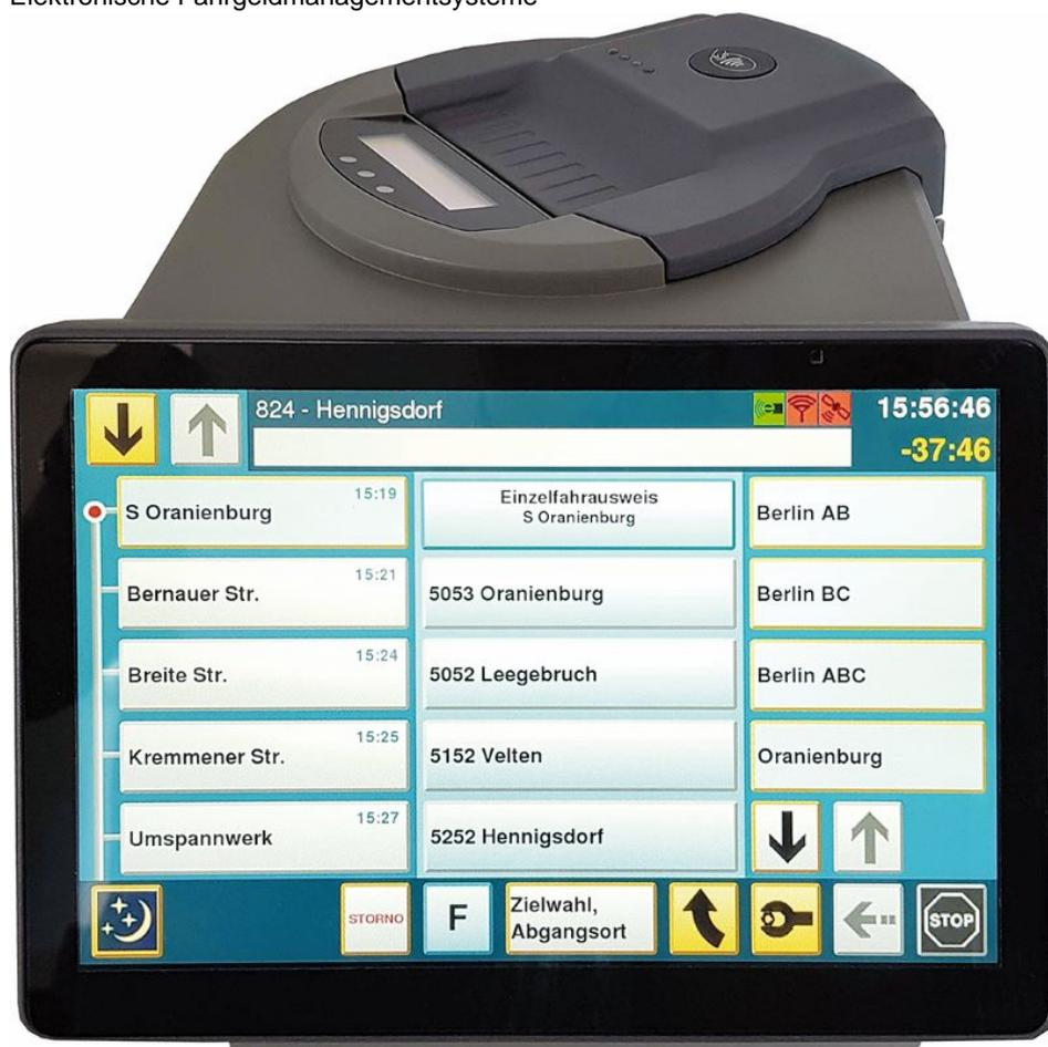
Über kontaktloses Bezahlen, beispielsweise mit Kreditkarte, wird ein schnellerer Papierverkauf durch den Bordrechner »AFR 4« ermöglicht (Bild: Atron).
