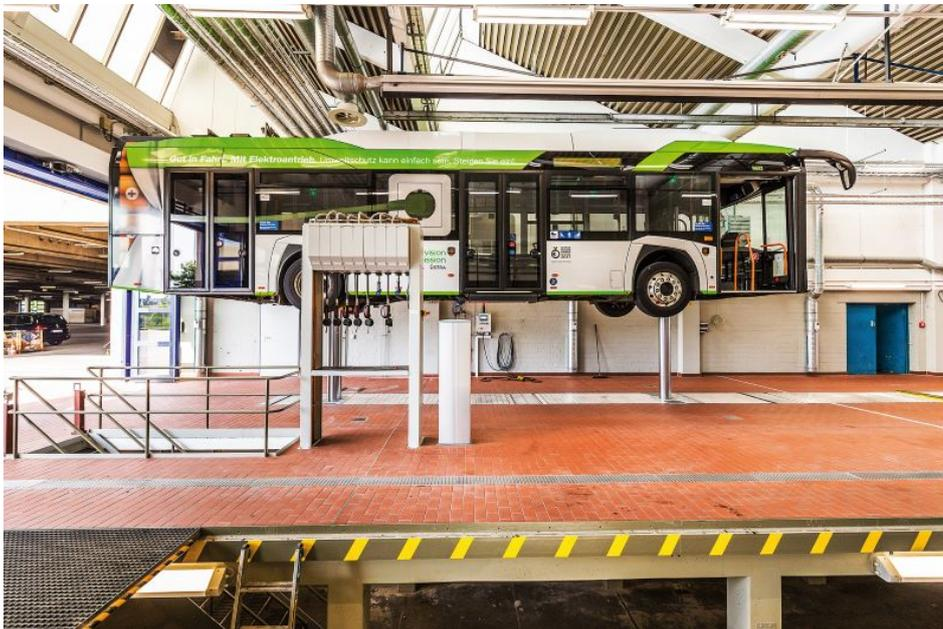
Die Hebeanlagen von JAB befördern praktisch alle Fahrzeuge bis hin zu Sonder- und Schienenfahrzeuge in eine ergonomische Arbeitshöhe (Bild: J. A. Becker)
