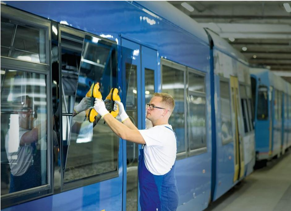
Schluss mit teuren Standzeiten – das schnellwechselfähige Fenstersystem ermöglicht den Fensteraustausch in unter 20 Minuten (Bild: Hübner).
