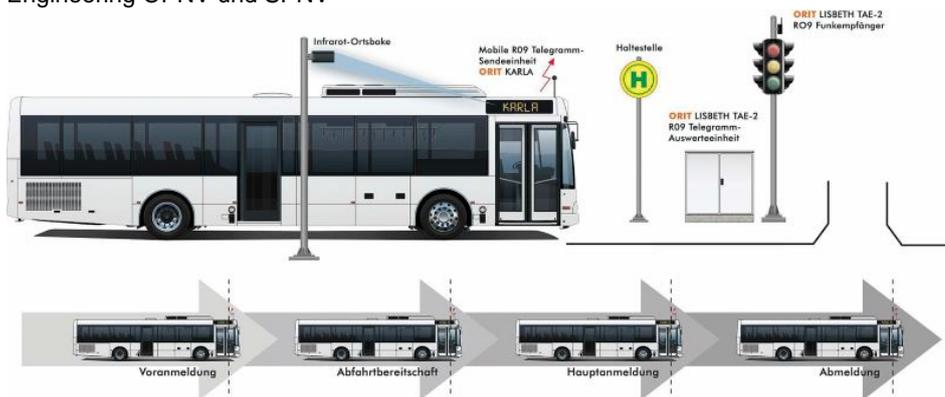
Mit Priorität durch den Verkehr. Laut Unternehmen ist der »Karla III« der derzeit kleinste am Markt befindliche Sender zur LSA-Beeinflussung (Bild: Meretec Technologies).
