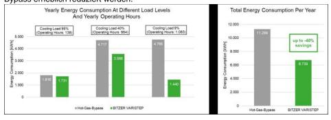
Die Berechnung basiert auf einer typischen in Mitteleuropa verwendeten leichten Klimaanlage für Schienenfahrzeuge. Zwei identische Kältekreisläufe werden verglichen, der eine mit VARISTEP und der andere mit Heißgas-Bypass. Die unterschiedlichen Kühllasten und Betriebszeiten im Laufe eines Jahres werden berücksichtigt. Wenn Teillastbetrieb häufig erforderlich ist, trägt die VARISTEP Technologie zu einer Reduzierung des Energieverbrauchs durch den Verdichter um bis zu 40 % bei (Bild: Bitzer).
