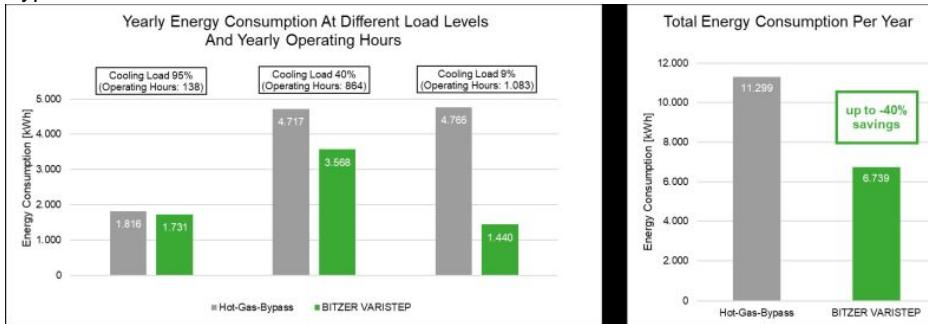
Die Berechnung basiert auf einer typischen in Mitteleuropa verwendeten leichten Klimaanlage für Schienenfahrzeuge. Zwei identische Kältekreisläufe werden verglichen, der eine mit VARISTEP und der andere mit Heißgas-Bypass. Die unterschiedlichen Kühllasten und Betriebszeiten im Laufe eines Jahres werden berücksichtigt. Wenn Teillastbetrieb häufig erforderlich ist, trägt die VARISTEP Technologie zu einer Reduzierung des Energieverbrauchs durch den Verdichter um bis zu 40 % bei (Bild: Bitzer).
