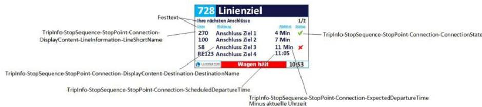
Das neue IBIS-IP CIS Tool ordnet alle CIS-IP Elemente und Datentypen einer empfohlenen Verwendung zu (Bild: Luminator Technology Group).
