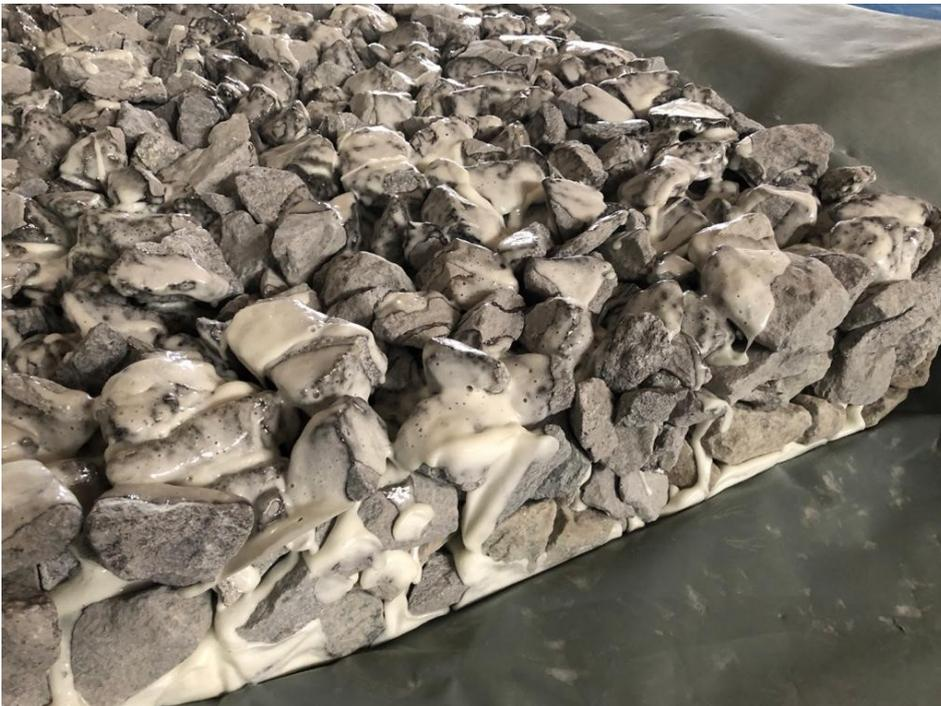
Der Schotter wird durch einen Polyurethanschaum zu einer Matte verklebt (Bild: Hyperion).
