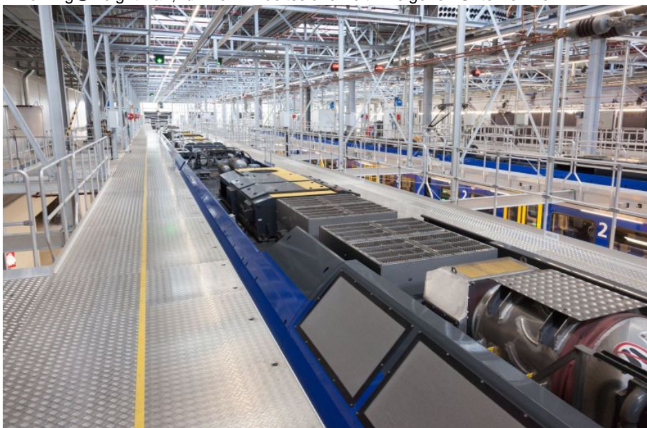
Stationäre Zugangslösung zu Schienenfahrzeugen über Dacharbeitsstände (Bild: Zarges).
