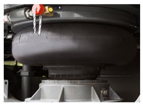
In Hamburg produzierte Luftfedersysteme sorgen für hohen Fahrkomfort in modernen DT5-Zügen der Hamburger Hochbahn (Bild: Contiental).
