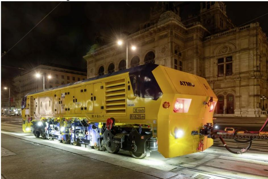
Der Schienenschleifanhänger »ATMO« (Automatic Track Machine Oscillator) kombiniert das klassische Rutschersteinschleifen mit dem oszillierenden Schleifen (Bild: Plasser+Theurer).
