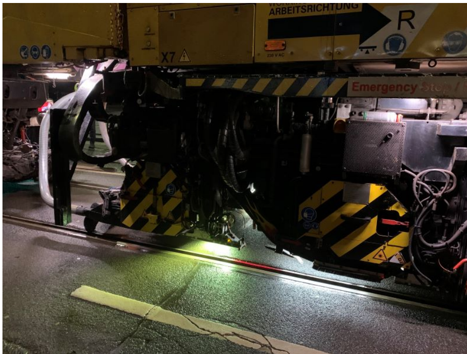
Abb. 3: Um eine frästechnische Bearbeitung von Rillenschienen trotz bündigem Fugenverguss entlang der Außenseite zu ermöglichen, entwickelte Vossloh ein speziell für diesen Anwendungszweck zugeschnittenes Fräs Werkzeug (Bild: Vossloh).
