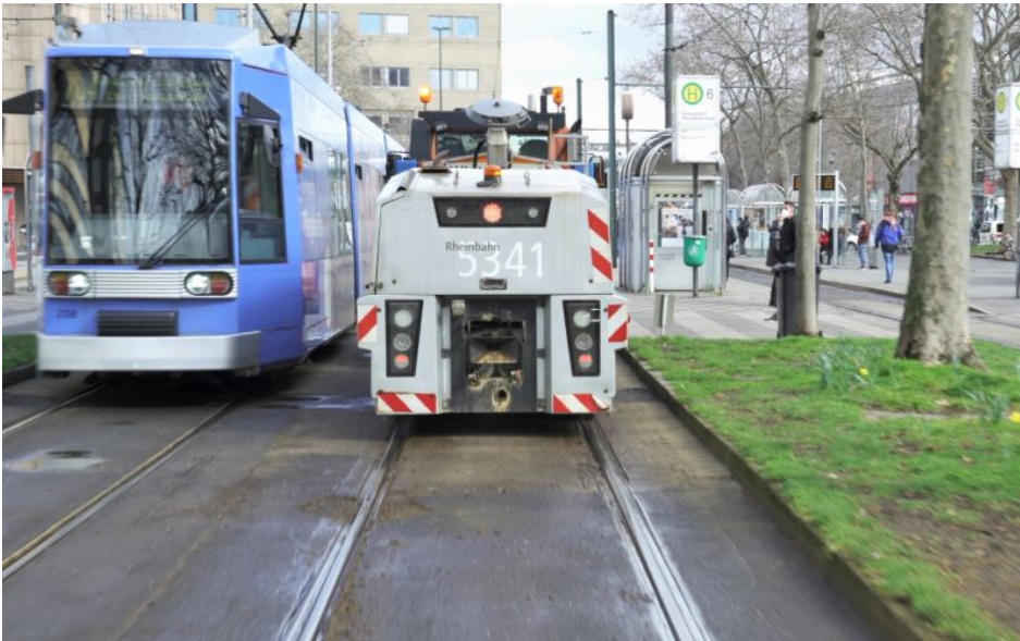
Abb. 1: Das größte Plus des HSG-city ist die hohe Arbeitsgeschwindigkeit, die ein Einsatz im laufenden Betrieb ermöglicht (Bild: Vossloh).
