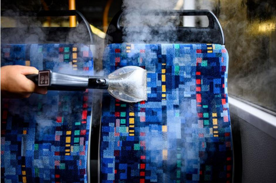
Das Gerät arbeitet mit heißem Trockendampf. Die Flächen sind deshalb sofort wieder trocken. Das minimiert die Standzeiten der Busse.
