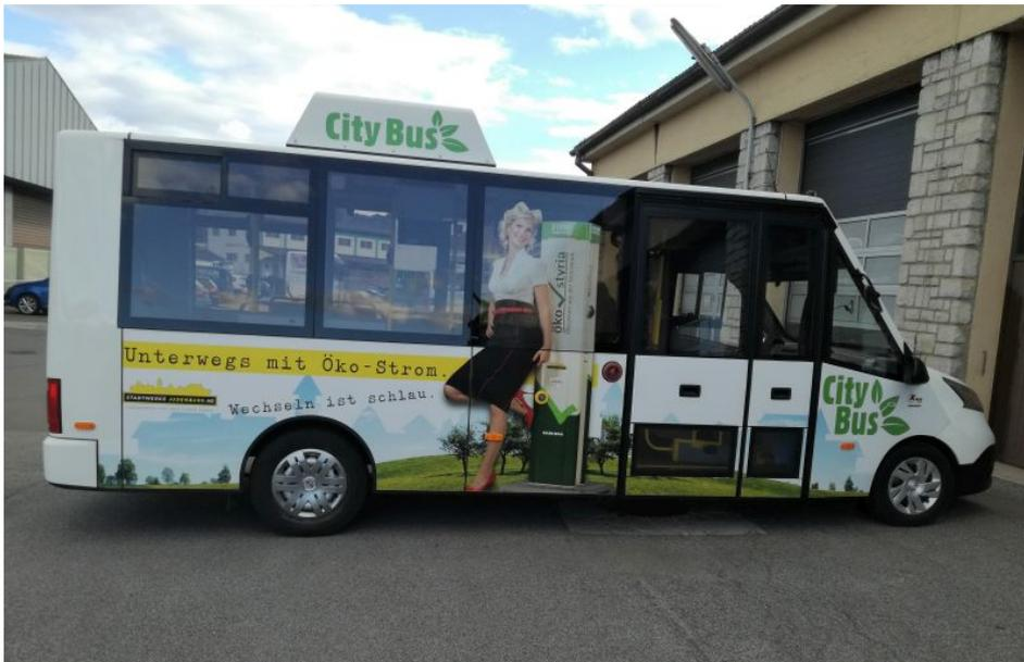
Der »E-Solar City« ist ein Kleinbus mit Solar-Panel auf dem Dach als Range-Extender (Bild: K-Bus).
