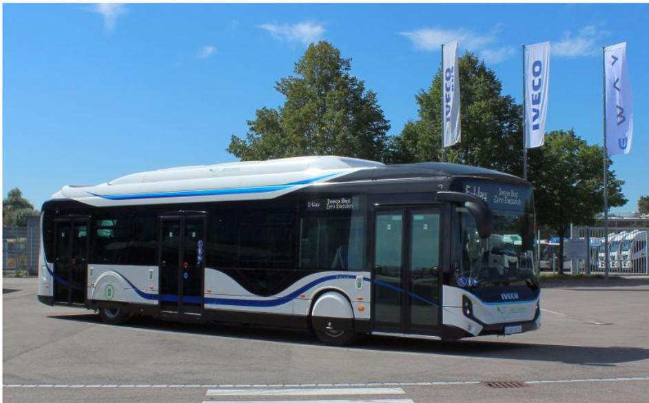
Während der Fahrt legte der mit einem 350-kWh-Akkupack (335kWh nutzbar) ausgestattete »E-Way«, nach Herstellerangaben 543 Kilometer zurück ohne nachzuladen (Bild: Iveco).
