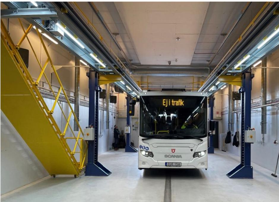
Busarbeitsbühnen von Pfaff Verkehrstechnik erleichtern Wartungs- und Instandhaltungsarbeiten an Bussen (Bild: Columbus McKinnon).
