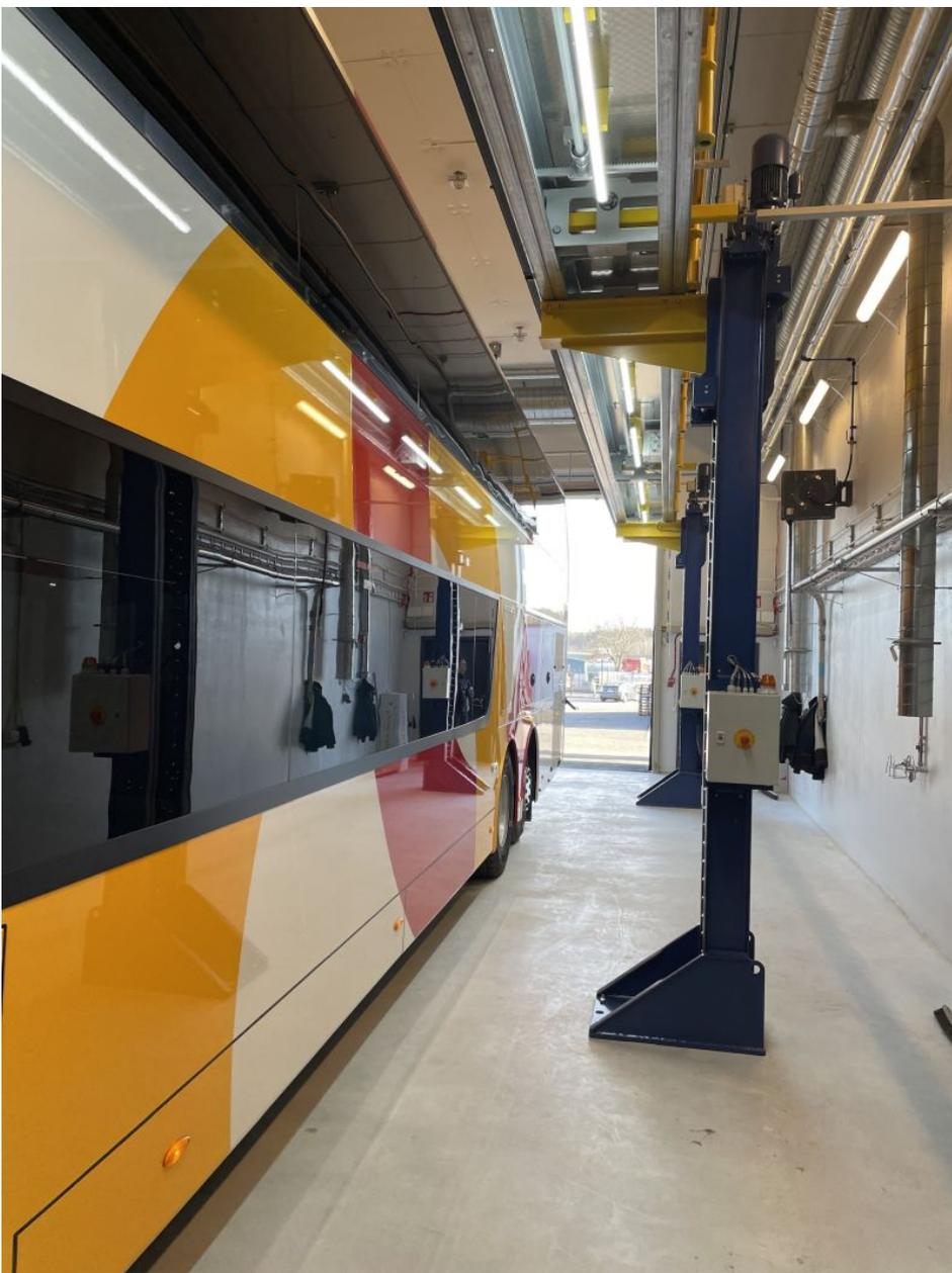
Auf drei Spindel-Hebeböcken an jeder Busseite befinden sich jeweils zwei ausfahrbare Arbeitsplattformen (Bild: Columbus McKinnon / Pfaff Verkehrstechnik).
