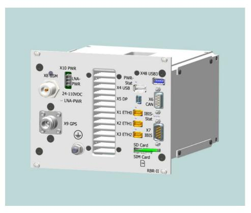
Neuer Bord-Rechner »RBR II« als Nachfolger des »RBR« (Bild: Dengler).
