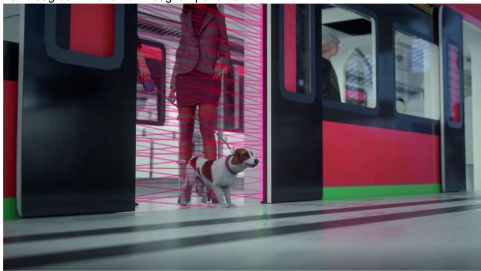
Das vollautomatische Lichtgitter »SITRANS alpha« steht für eine berührungslose Türüberwachung. Weltweit wurden bereits mehr als 138.000 Türen damit ausgerüstet (Bild: Sitron).
