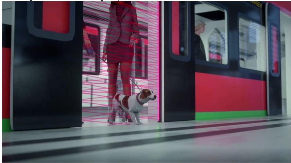
Das vollautomatische Lichtgitter »SITRANS alpha« steht für eine berührungslose Türüberwachung. Weltweit wurden bereits mehr als 138.000 Türen damit ausgerüstet (Bild: Sitron).
